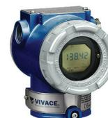
O VRI10-P é um indicador remoto Profibus-PA de até 10 indicações de variáveis de outros equipamentos na rede PA e que trabalha como um "sniffer", sem troca de dados cíclicos com o mestre Profibus.
