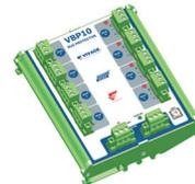
O VBP10 garante a proteção contra curtos-circuitos nas derivações (spurs) em redes Profibus-PA e FOUNDATION™ fieldbus, evitando que o curto-circuito se propague entre as derivações ou mesmo para o tronco principal.
