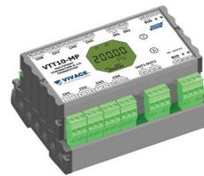
O VTT10-MP é um transmissor Profibus-PA com 8 pontos de temperatura, 2 canais de entradas analógicas e 2 canais de saídas 4-20 mA, configuráveis pelo usuário. Possui indicador LCD multifuncional, ajuste local e pode ser configurável via DTM ou EDDL.
