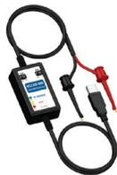
A VCI10-UH é uma interface de comunicação HART® para utilização com dispositivos que possuam conexão USB tipo-A padrão.
