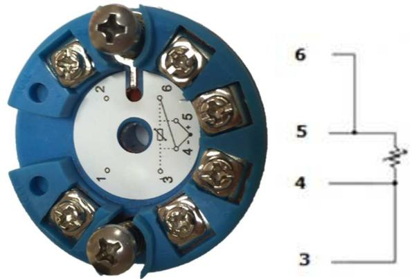
Figura 2.6 - Conexión RTD o resistivo a 3 hilos.
