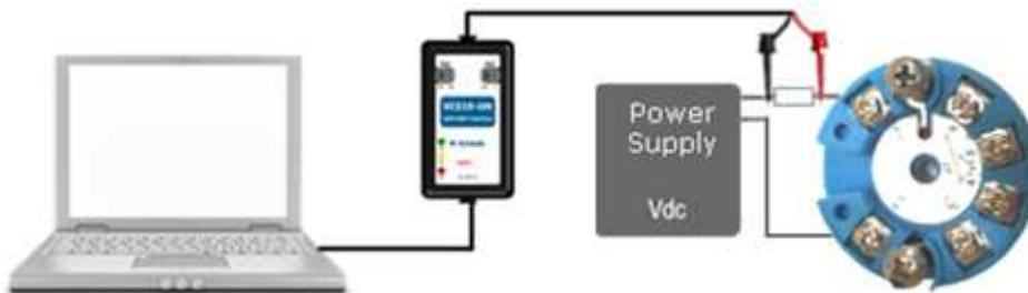
Figura 3.1 - Esquema de conexión de la interfaz VCI10-UH al VTT10-HH con alimentación externa.
