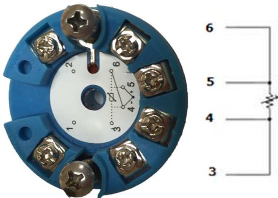
Figura 2.7 - Conexión RTD o resistivo a 4 hilos.
