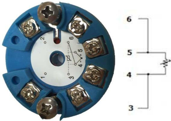
Figura 2.5 - Conexión RTD o resistivo a 2 hilos.
