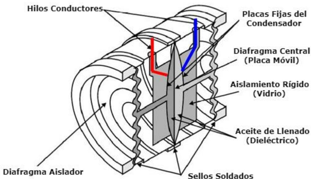
Fig. 1.1 – Esquema de la Célula Capacitiva.
