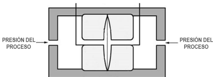
Son transmisores en los que la presión del proceso se aplica en los lados de alta y baja del transmisor. El VPT10-H se utiliza para procesos de alta presión estática.
