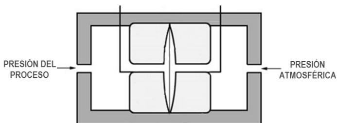
En este tipo de transmisor la presión del proceso se aplica en el lado de alta del transmisor y el lado de baja se abre a la atmósfera, por lo que la presión atmosférica es la referencia para el sensor capacitivo.
