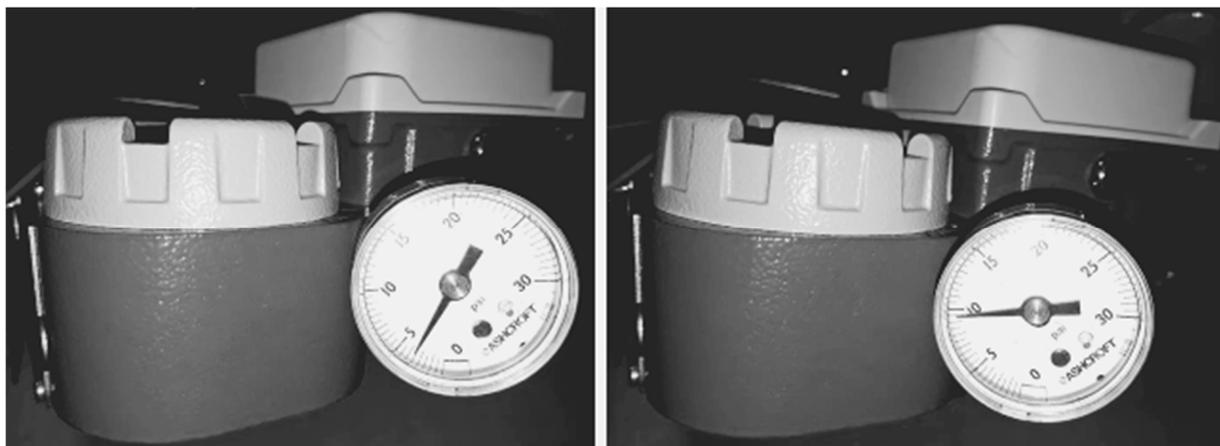
Figura 3.3 – Pressões piloto para CWR em 0% e 100%, respectivamente.
