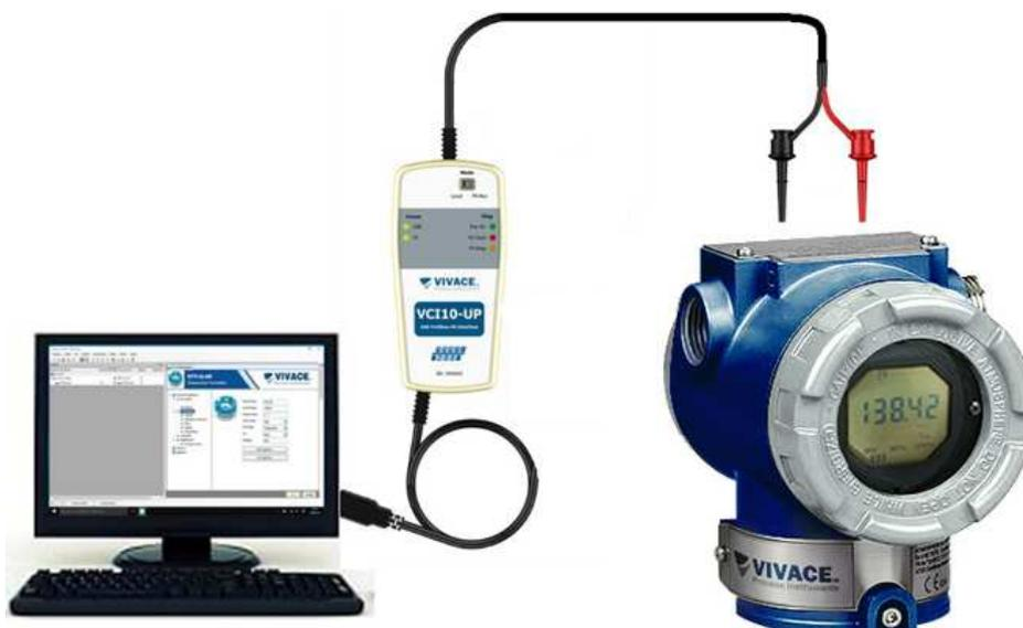
Figura 3.5 – Esquema de configuración del VAP10 con VCI10-UP.
