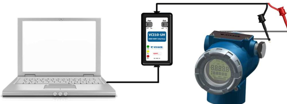
Figura 2.2 - Configuración de la interfaz con alimentación del equipamiento via interfaz.
