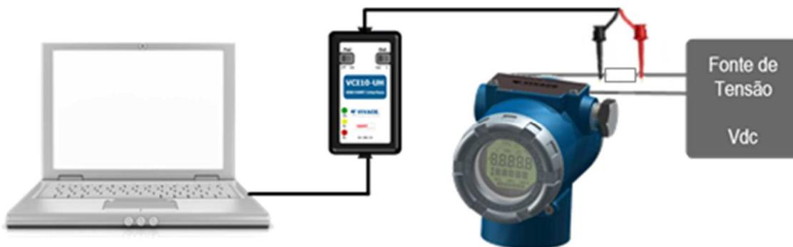
Figura 2.1 – Configuración de la interfaz con alimentación externa del equipo.
