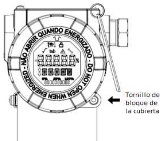
Figura 2.2 – Bloque de la cubierta con pantalla.
