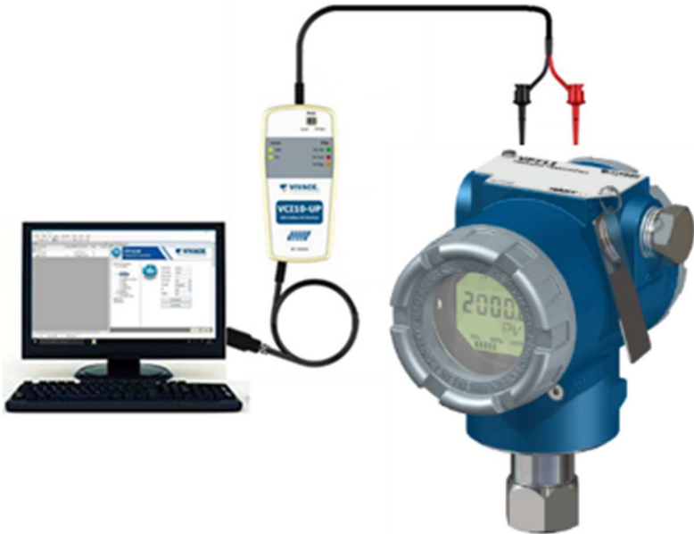
Figura 3.4 – Esquema de conexión del VPT11-P con la VCI10-UP.
