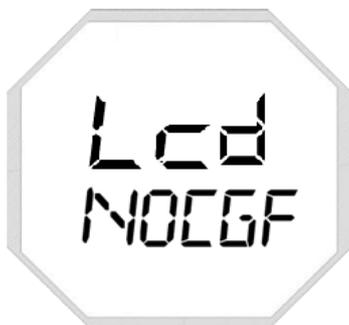
Figura 3.7 – No hay configuración em el LCD.
