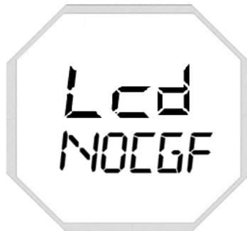
Figura 3.7 – Indicação de LCD sem configuração.
