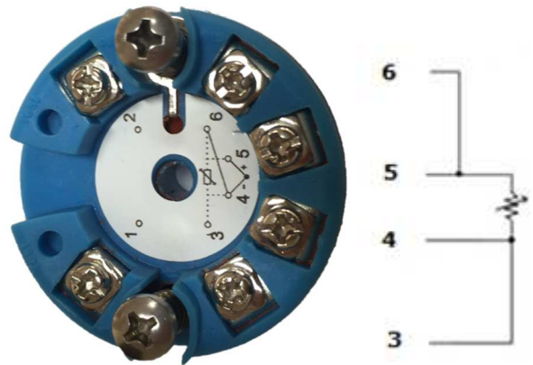
Figura 2.6 - Conexão RTD ou resistivos a 3 fios.
