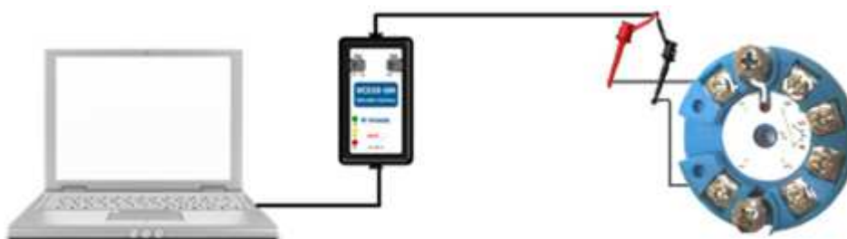
Figura 3.2 - Esquema de ligação da interface VCI10-UH alimentando o VTT10-HH.
