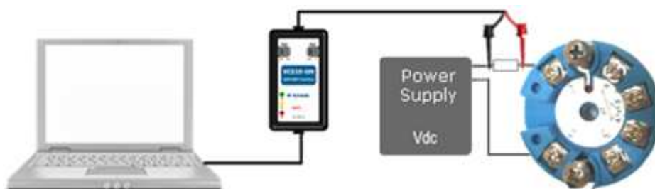
Figura 3.1 - Esquema de ligação da interface VCI10-UH ao VTT10-HH com alimentação externa.
