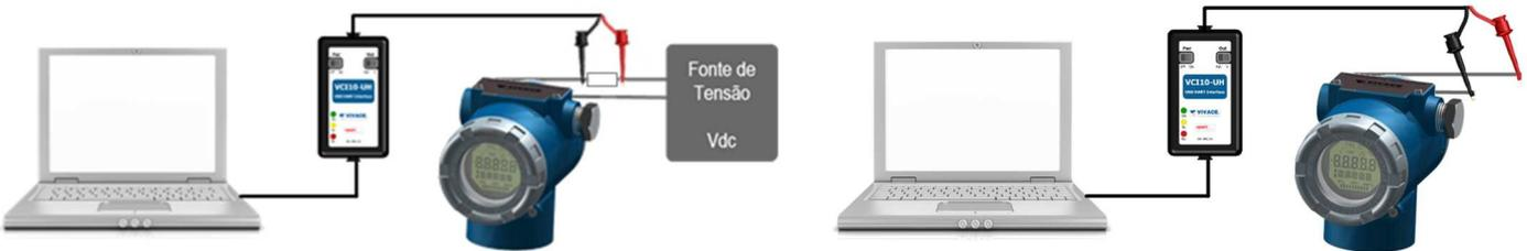
Conexão com alimentação externa do equipamento.
