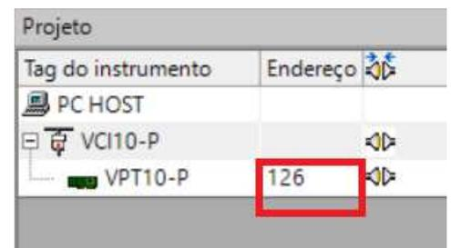
Em *Set DTM Address*, configure o endereço do equipamento Profibus PA (o mesmo endereço físico do equipamento). Após essa operação, observe se o endereço configurado, aparece na topologia do PACTware.
