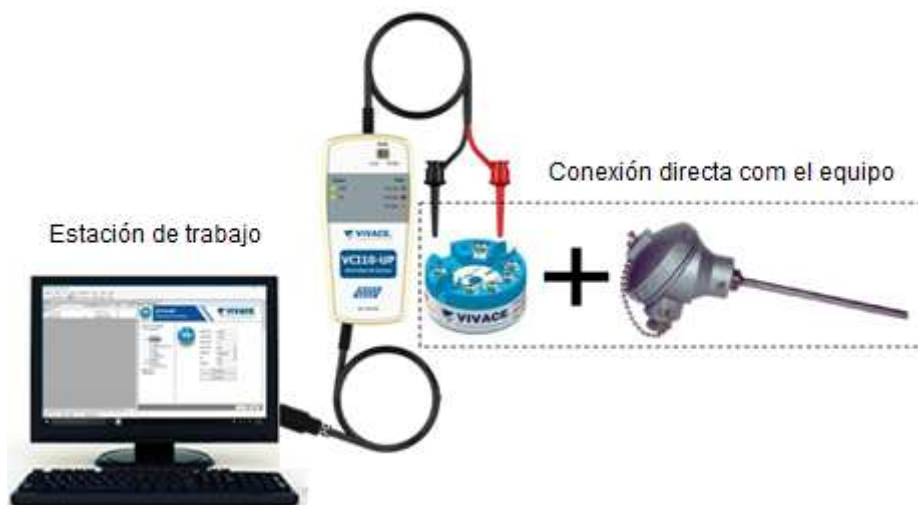
Figura 4.2: Esquemático de interconexión para el modo de operación "Local".
