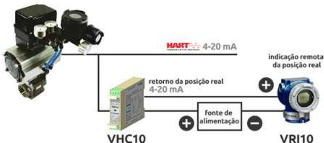
Figura 2.11 – VRI10-I conectado a um VHC10 para mostrar a posição real da válvula.
