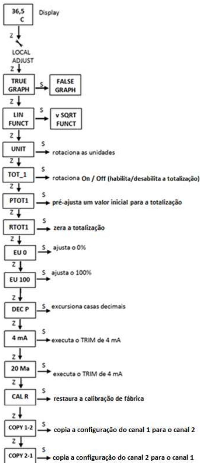
Figura 3.5 - Árvore de configuração do ajuste local do VRI10-I de 1 canal.
