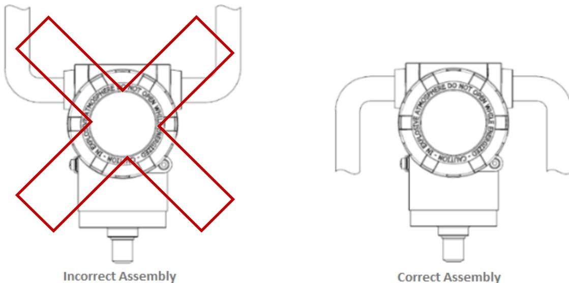
Figure 2.10 – Conduit installation.
