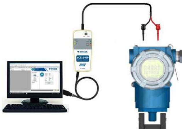
Figura 3.5 – Esquema de conexión de interfaz VCI10-UP a VTP10-P.
