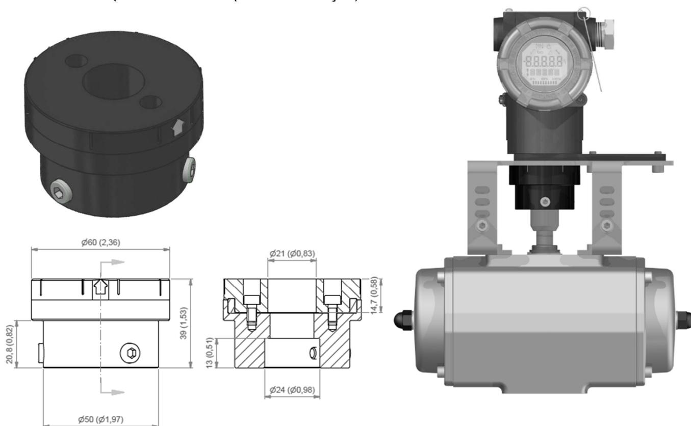
Figura 2.11 – Dimensional e montagem do ímã rotativo.
