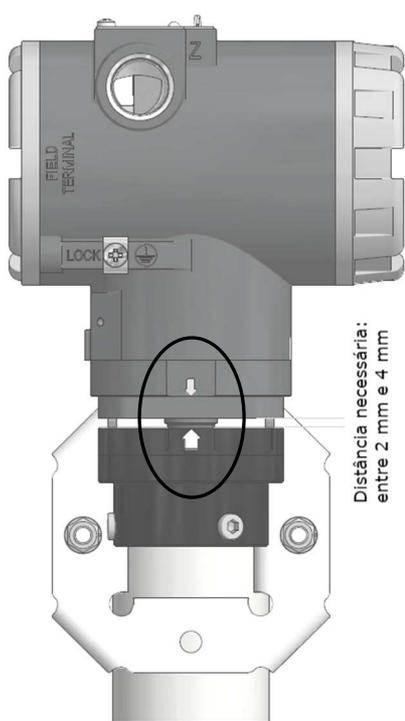
Figura 2.5 – Montagem do VTP10-P em ímã rotativo.
