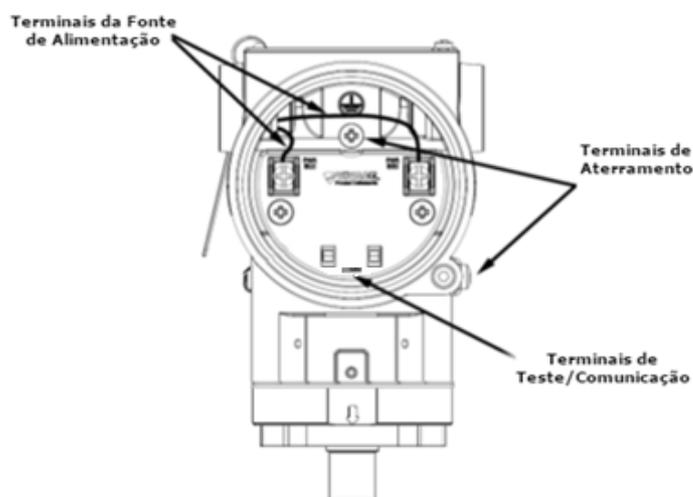
Figura 2.9 – Conexões e descrição dos terminais do VTP10-P.
