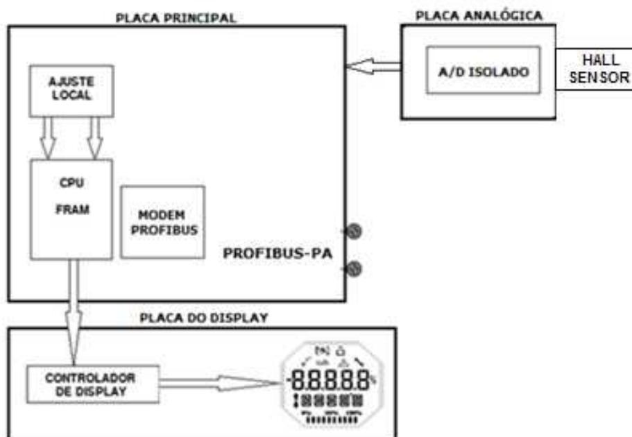
Figura 1.1 – Diagrama de blocos do VTP10-P.
