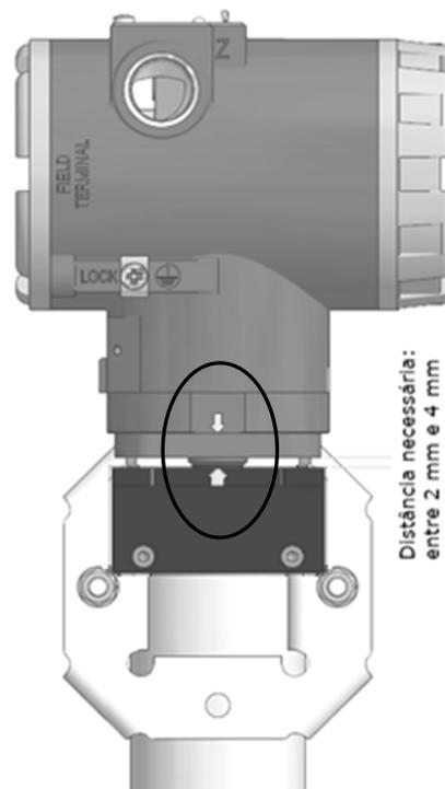
Figura 2.6 – Montagem do VTP10-P em ímã linear.
