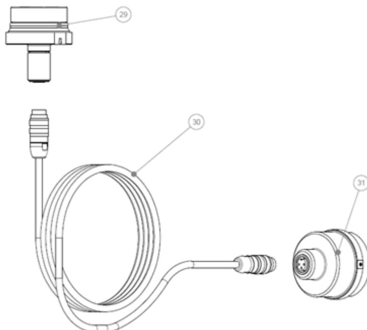
Figura 4.2 – Desenho explodido do sensor remoto do VTP10-P.
