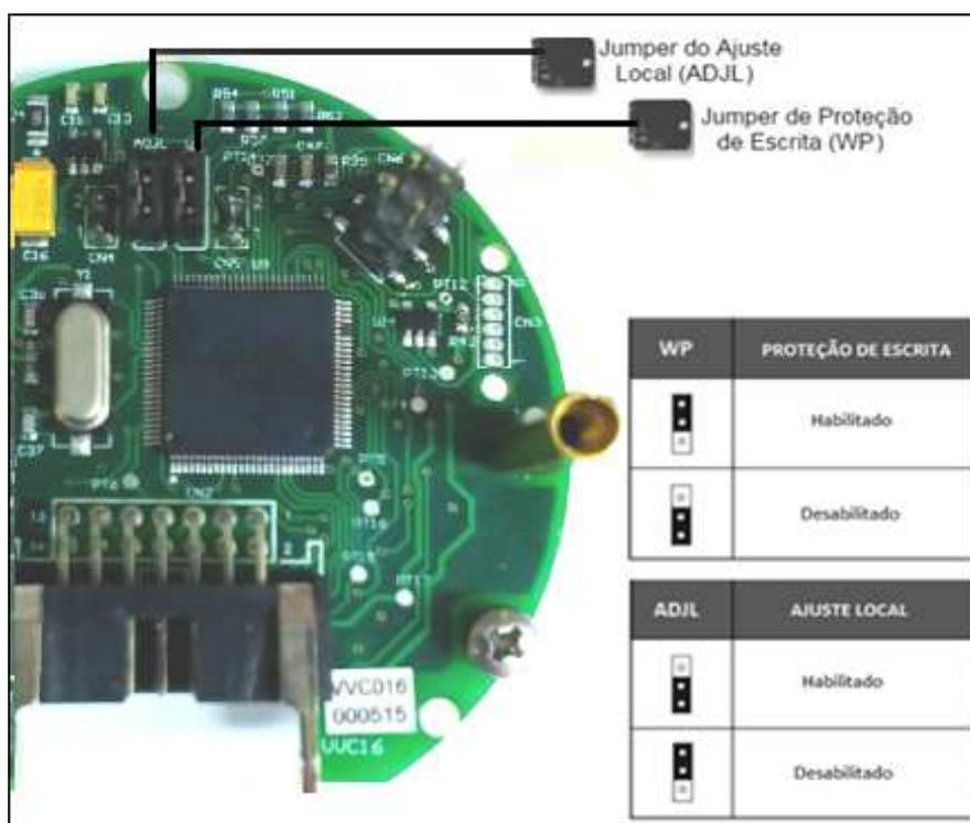
Figura 3.2 – Detalhe da placa principal com jumpers
