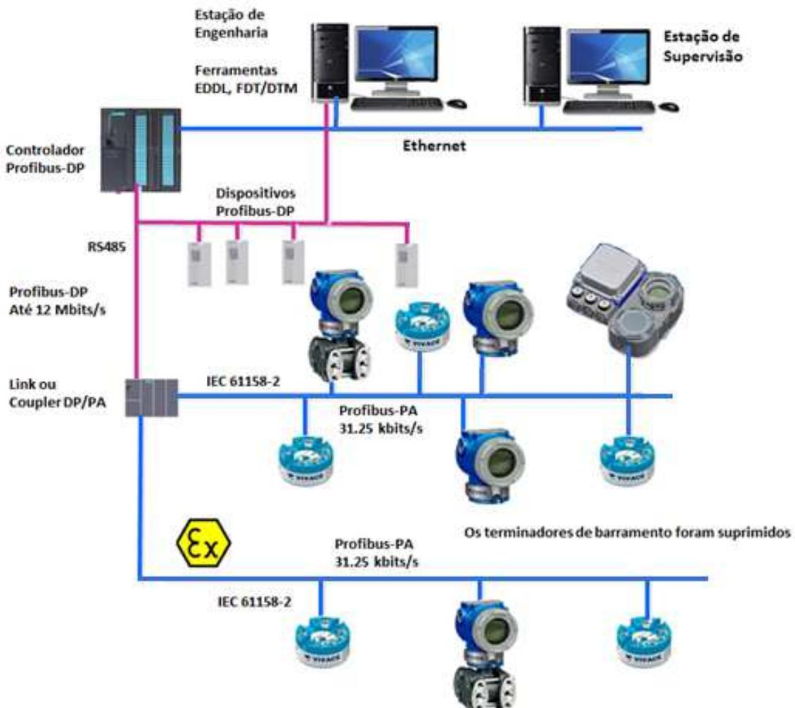
Figura 2.15 – Ligação de um equipamento Profibus-PA no barramento.
