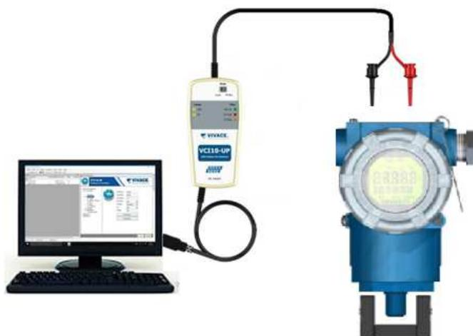
Figura 3.5 – Esquema de configuração do VTP10-P com a VCI10-UP.
