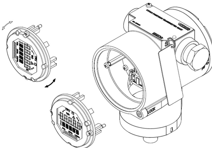
Figura 2.4 – Rotação do display digital LCD 4 x 90°
