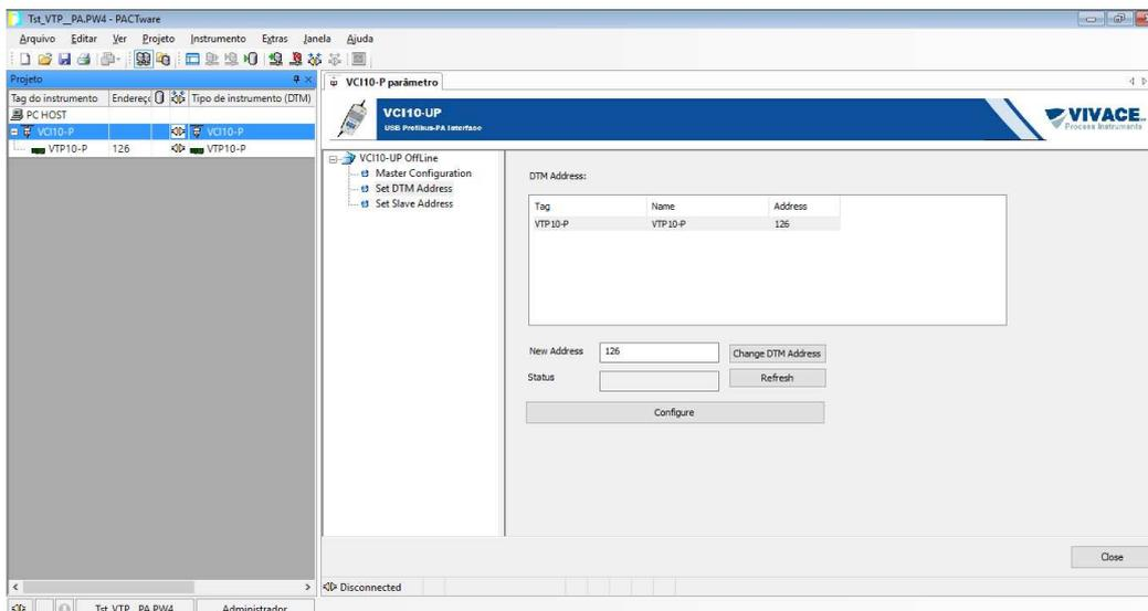
Figura 3.12 – Tela de configuração da interface de comunicação no PACTware.
