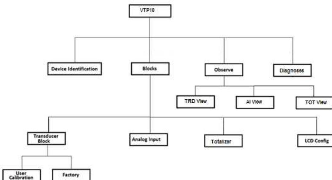
Figura 3.6 – Árvore de programação do VTP10-P.
