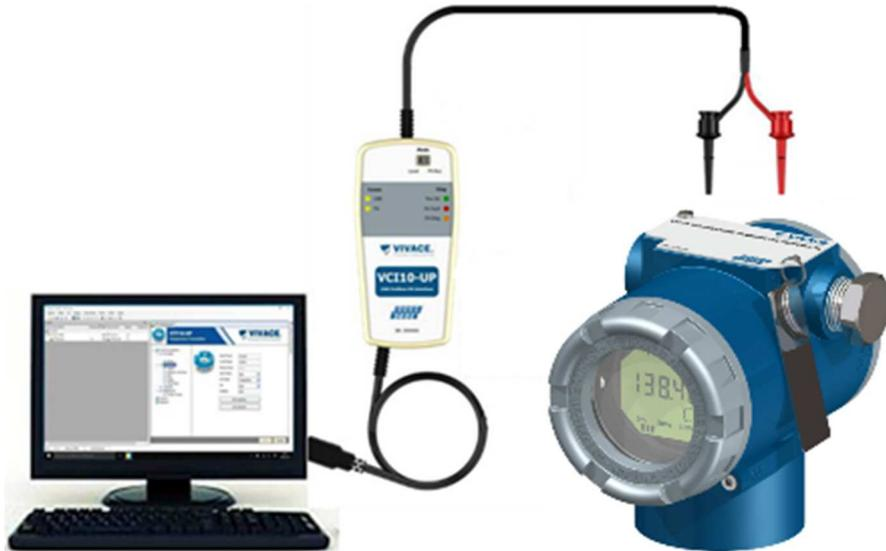
Figura 3.5 – Esquema de configuración del VTT10-FP con la VCI10-UP.
