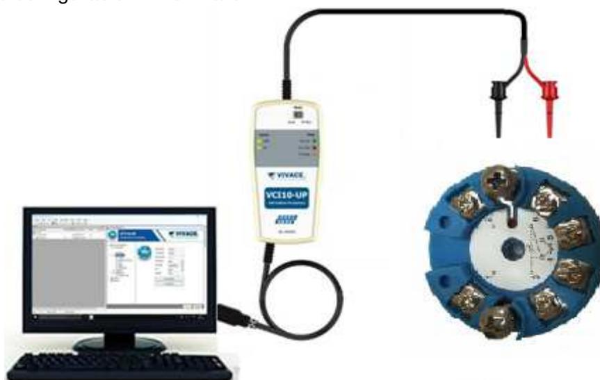
Figura 3.1 – Esquema de configuración del VTT10-HP con la VCI10-UP.
