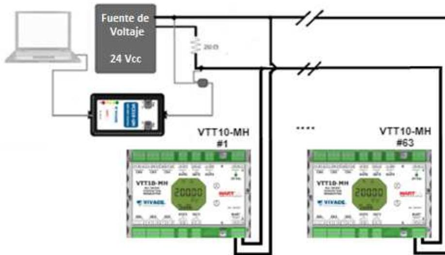
Figura 3.7 – Esquema de ligación de la interfaz al VTT10-MH en configuración *multidrop*.
