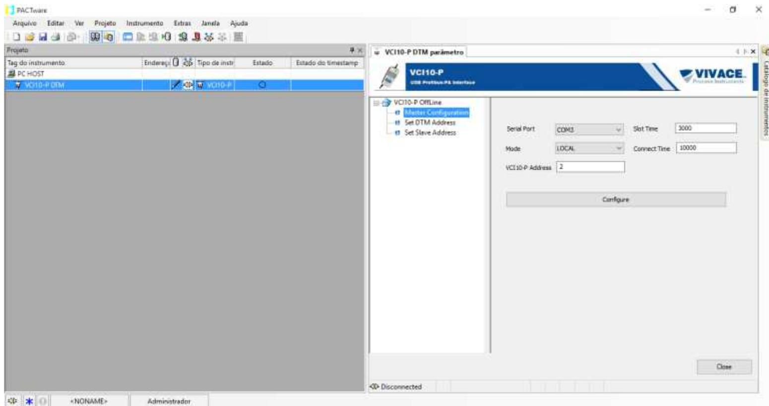
Figura 9: Campo ajustável na tela de parametrização VCI10-UP.
