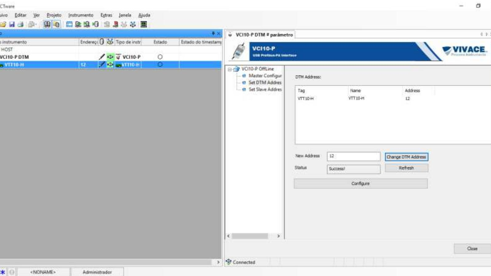
Figura 14: Confirmação da conexão a um instrumento na arquitetura FDT/DTM.
