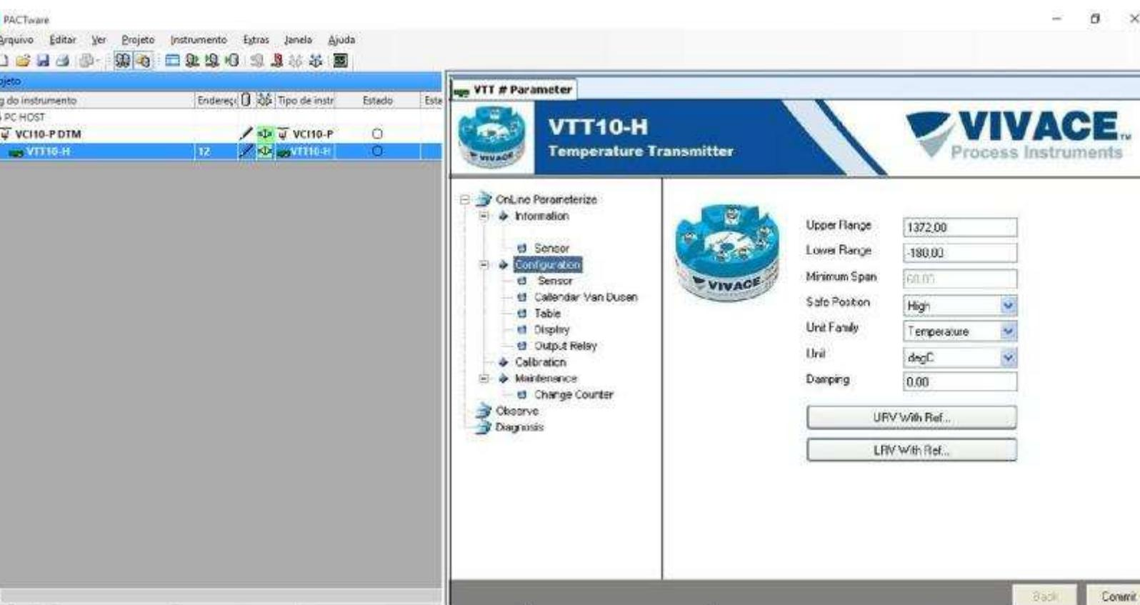
Figura 16: Navegação online pelo menu de um instrumento na arquitetura FDT/DTM.
