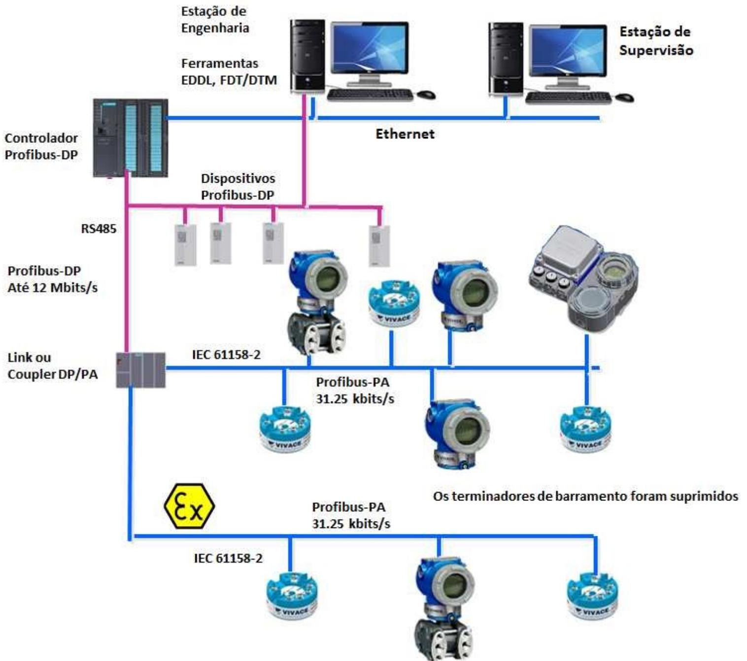
Figura 1 – Arquitetura típica Profibus.
