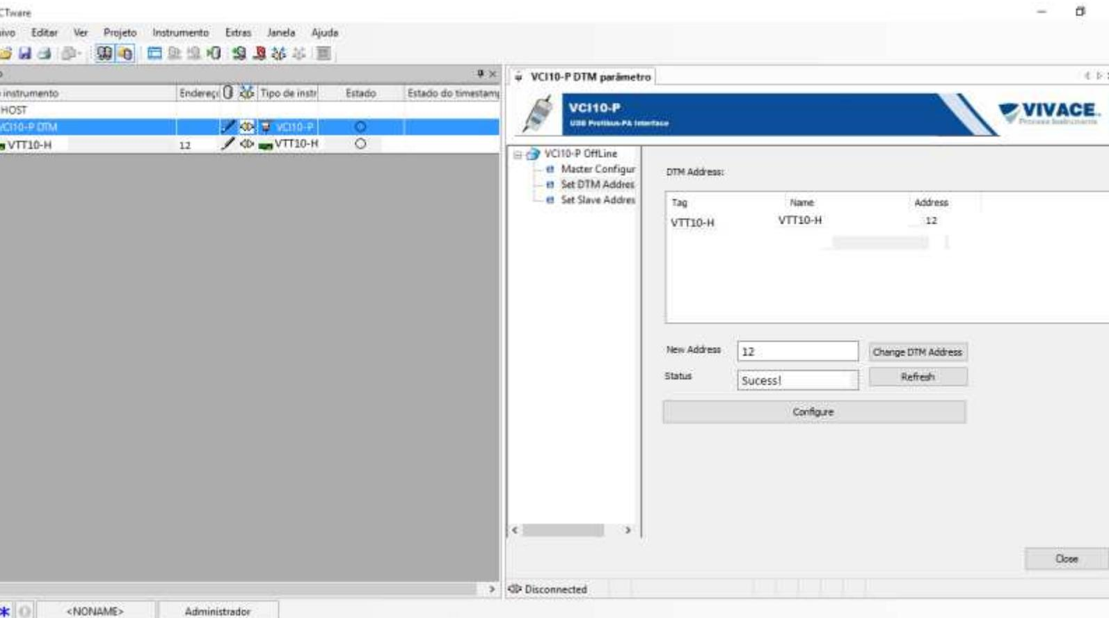
Figura 12: Sucesso na mudança de endereço de um instrumento na arquitetura FDT/DTM.
