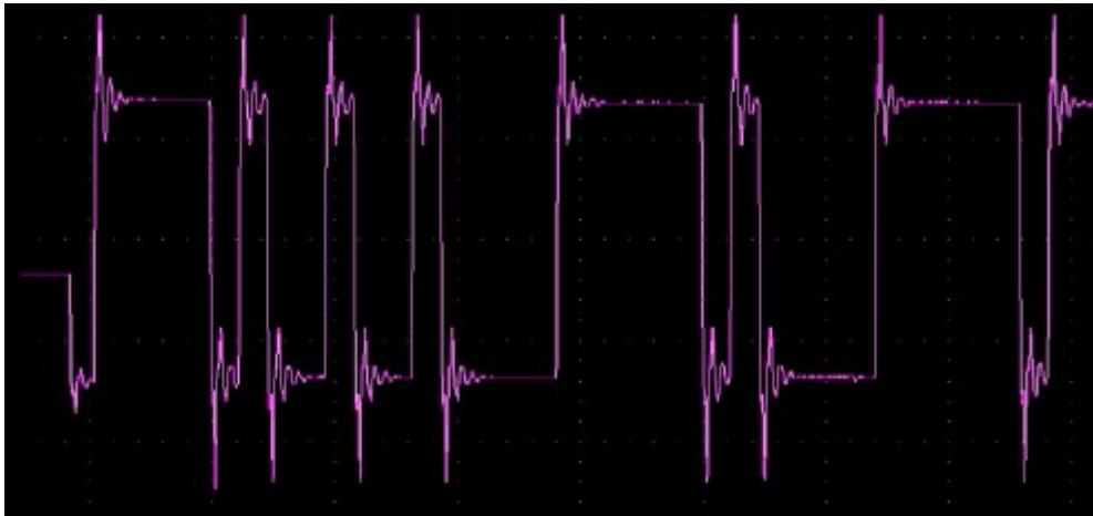
Figura 5 – Sinal Profibus-DP com reflexões.
