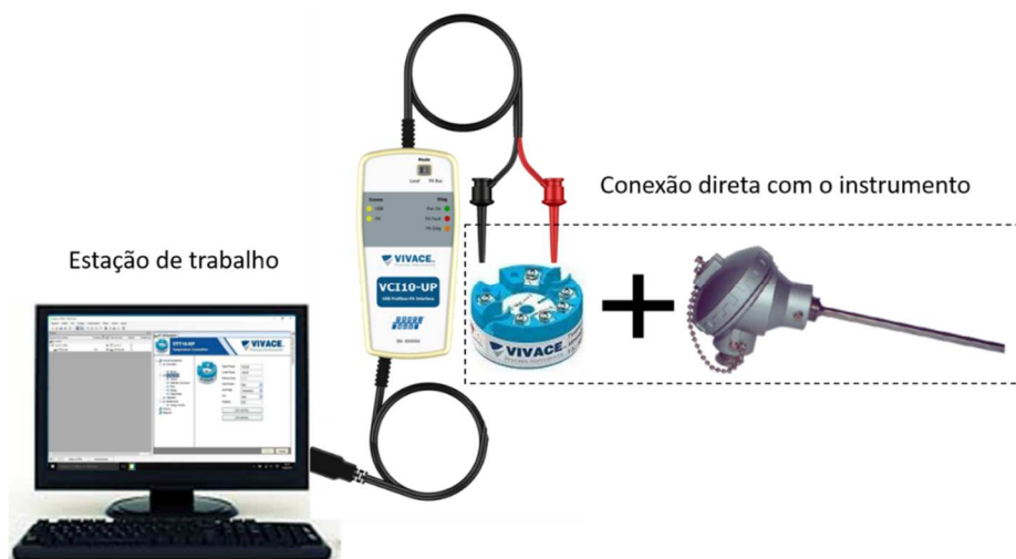
Figura 4.2: Esquemático de interconexão para o modo de operação “Local”.
