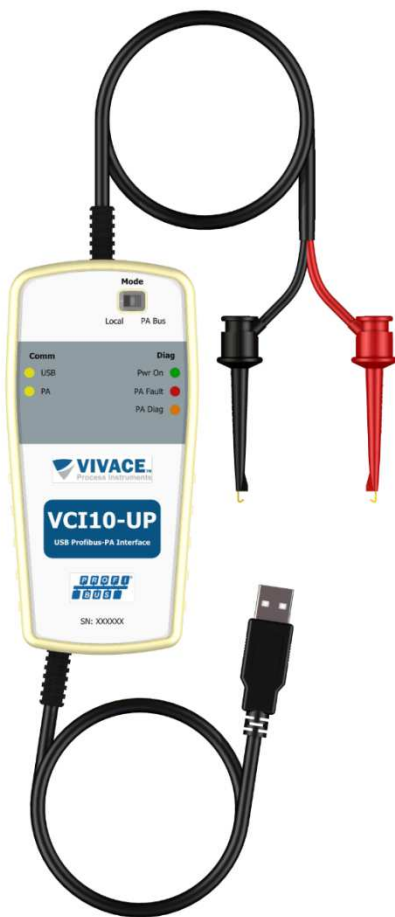
Figura 1.2: Indicação das conexões da VCI10-UP, USB (em baixo) e as garras retráteis (acima).
