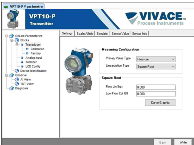
Figura 3.9 – Tela de configuração do VPT10 PROFIBUS.
