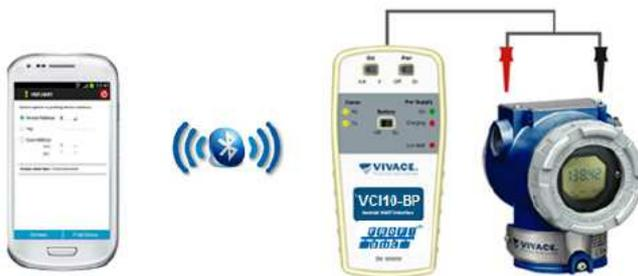
Quando este modo de operação é selecionado, a VCI10-BP pode alimentar diretamente o instrumento a ser configurado ou parametrizado, e ainda, trabalhar em paralelo com equipamentos já energizados por um acoplador PROFIBUS DP/PA.
