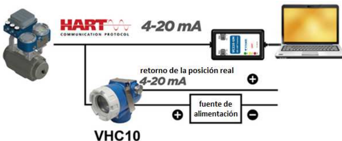
Figura 3.1 – Instalación del convertidor para configuración.
