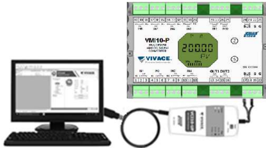
Figura 3.5 – Esquema de configuración del VMI10-P con la VCI10-UP.
