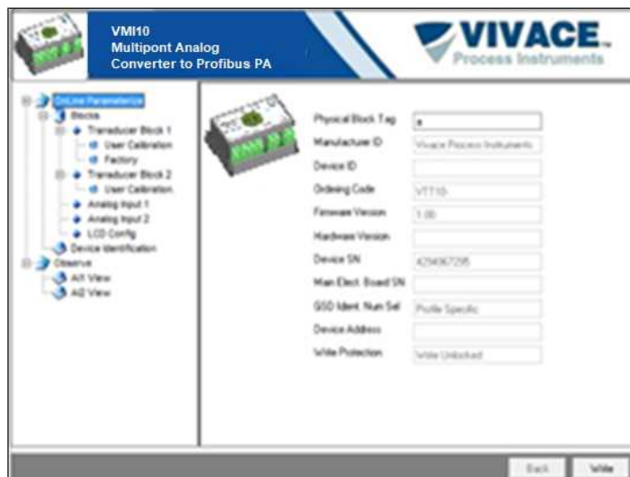
Figura 3.8 – Pantalla de visualización de las informaciones del VMI10-P en PACTware.
