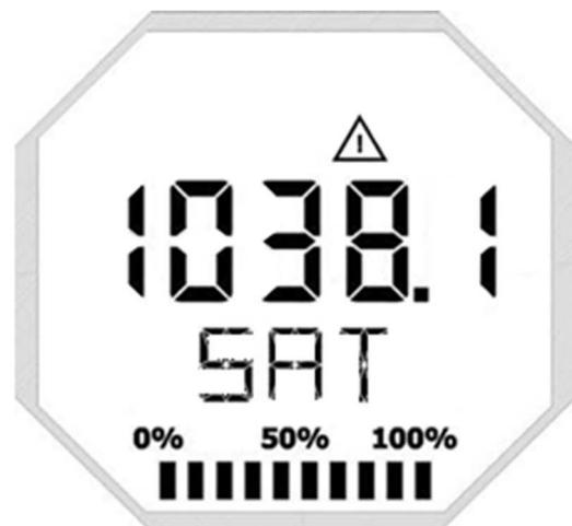
Figura 3.14 – Indicação de saturação da medição.
