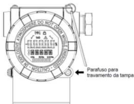
Figura 2.2 – Trava da tampa com visor.
