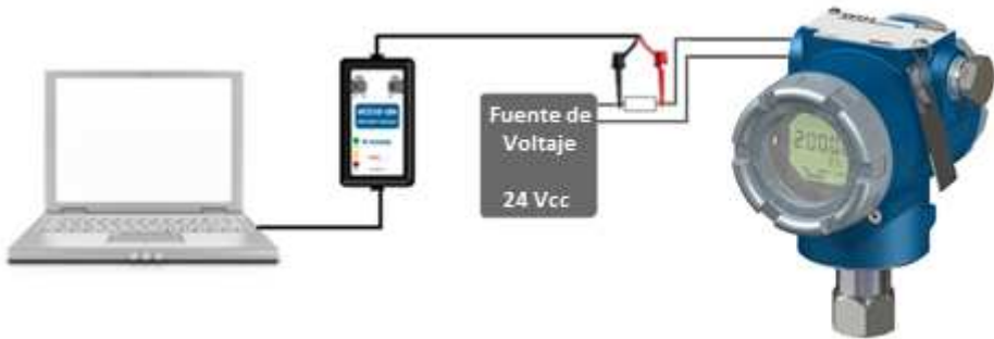
Figura 3.4 - Esquema de conexión de la interfaz VCI10-UH al VPT11-H con alimentación externa.
