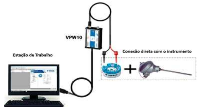
Figura 8.2 – Conexão para o modo de operação "Local".
