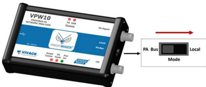
Figura 8.1 – Chave seletora para o modo de operação "Local".
