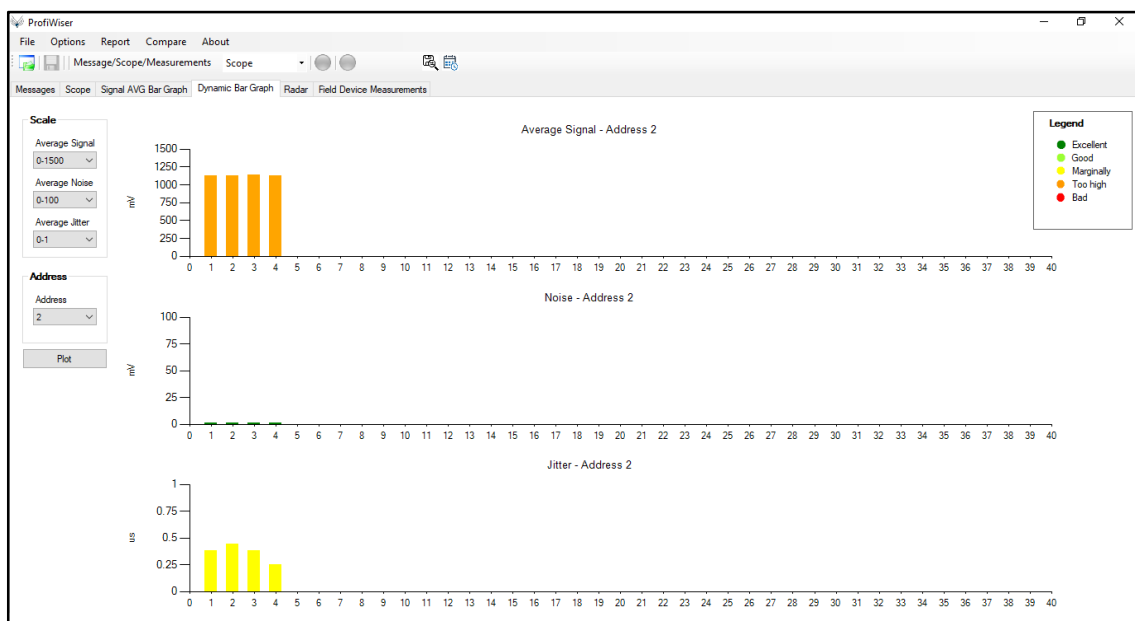
Figura 5.19 – Valores dinâmicos: média do sinal, média do ruído e jitter por endereço.
