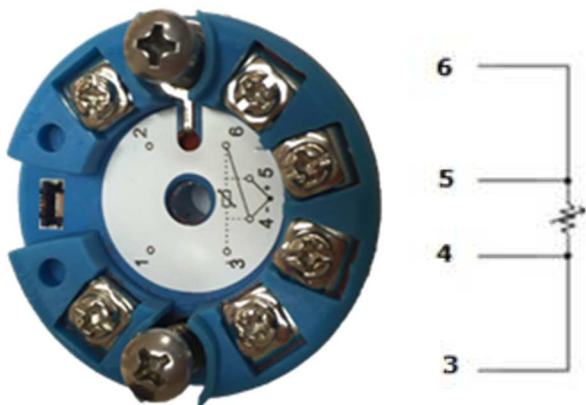
Figura 2.7 - Conexión RTD o resistivo a 4 hilos.
