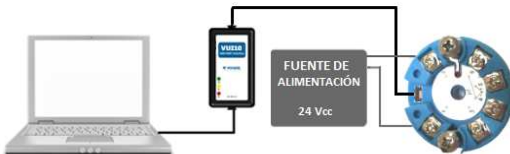
Figura 3.1 - Esquema de conexión de la interfaz VUI10 al VTT01-H con alimentación externa.
