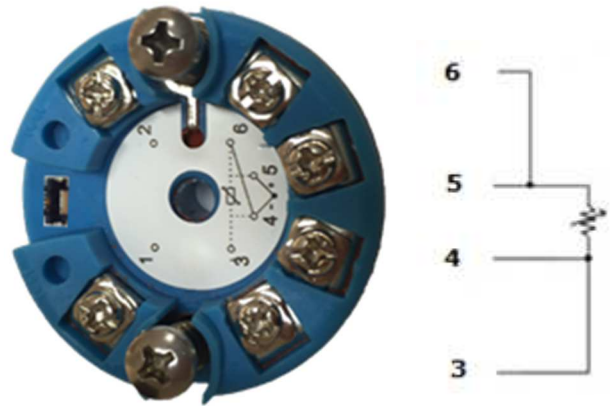
Figura 2.6 - Conexión RTD o resistivo a 3 hilos.
