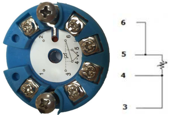
Figura 2.4 - Conexão RTD ou resistivos a 3 fios.
