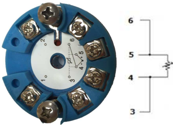
Figura 2.3 - Conexão RTD ou resistivos a 2 fios.
