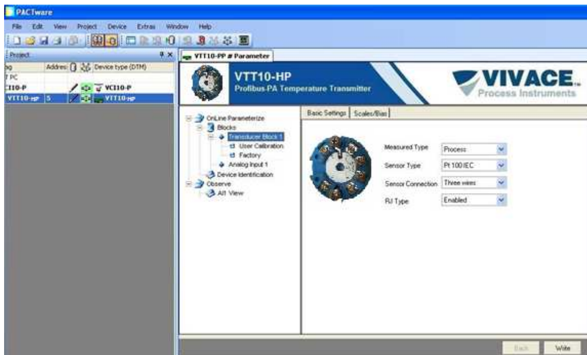
Figura 3.3 – Tela de configuração do VTT10-HP no PACTware.
