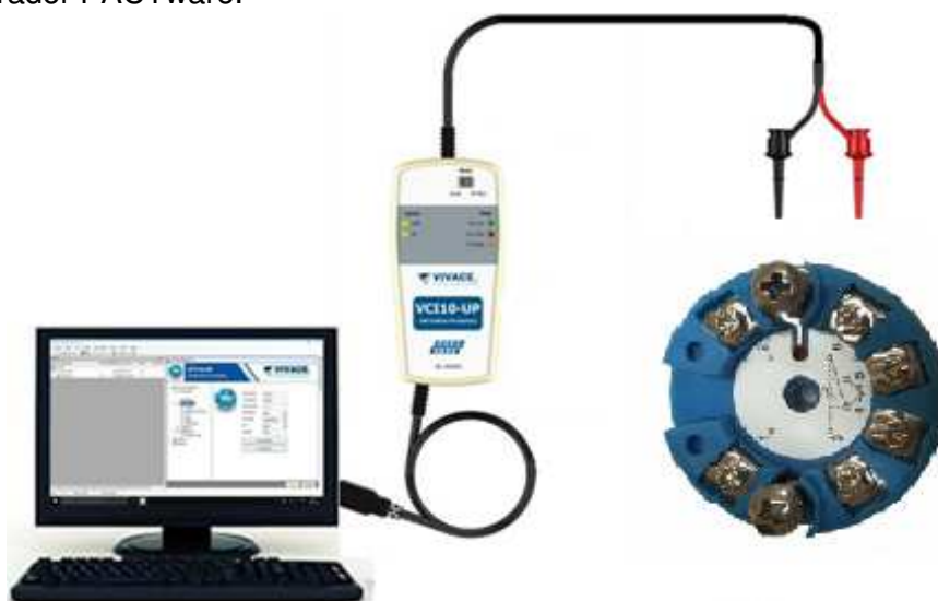
Figura 3.1 – Esquema de configuração do VTT10-HP com a VCI10-UP.
