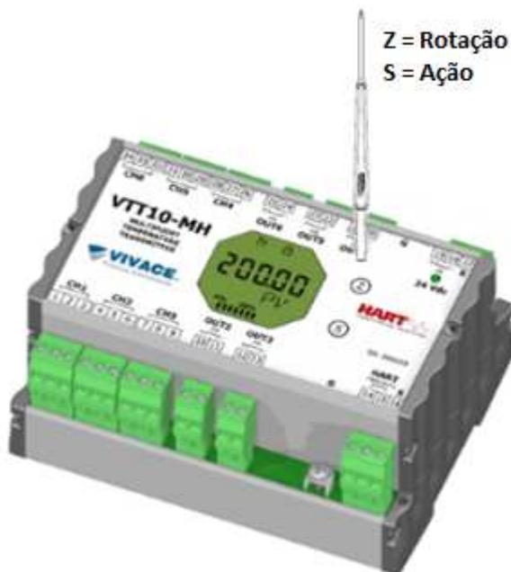
Figura 3.1 – Z e S do ajuste local e chave magnética.
