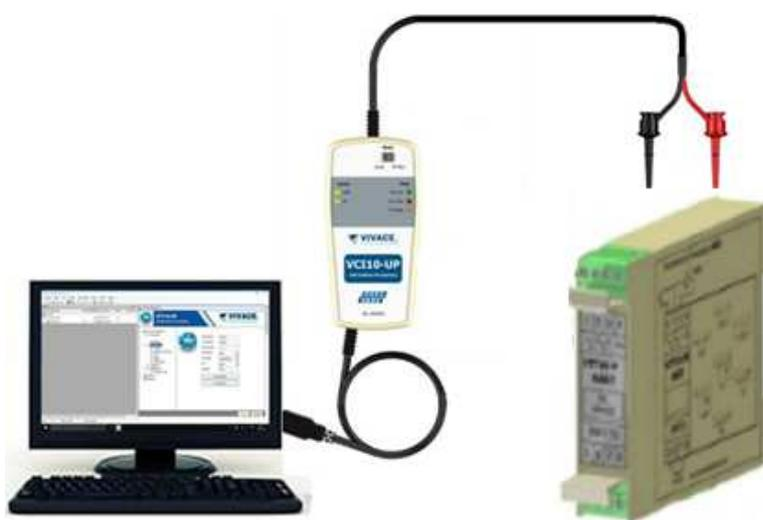
Figura 3.1 - Esquema de conexión de la interfaz VCI10-UP al VTT10-PP.
